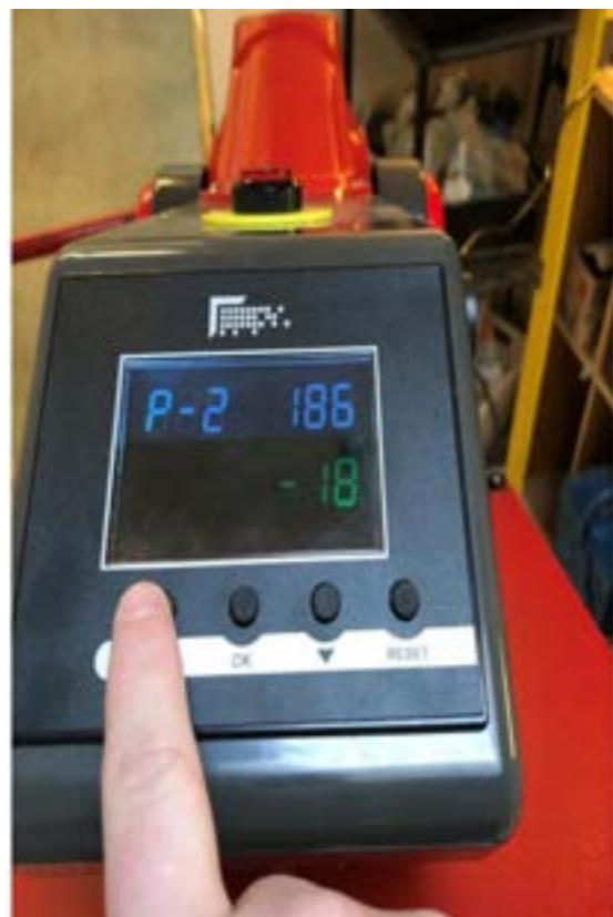
4) Efter kalibrering holdes OK tasten nede igen for at komme tilbage til det normale billede.
